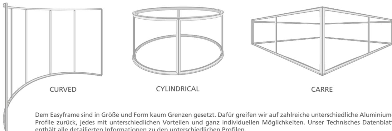
Dem Easyframe sind in Größe und Form kaum Grenzen gesetzt. Dafür greifen wir auf zahlreiche unterschiedliche Aluminium-Profile zurück, jedes mit unterschiedlichen Vorteilen und ganz individuellen Möglichkeiten. Unser Technisches Datenblatt enthält alle detaillierten Informationen zu den unterschiedlichen Profilen.
